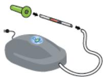
13. Iniziare la temporizzazione . Dopo 2 minuti collegare il lato opposto del tubo indicatore alla pompa di aspirazione attraverso il tubo di collegamento.
