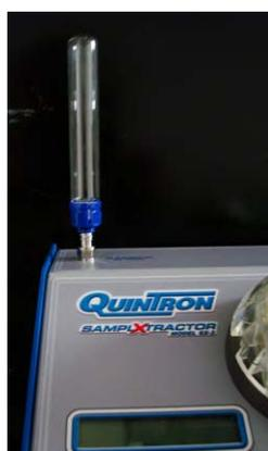
Il **SamplXtractor SX-2 Plus™** estrae il campione, di espriato alveolare, dal tubo di vetro, forando il tappo di elastomero, attraverso un processo utilizzando una pompa peristaltica temporizzata.
