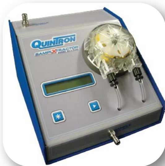
L'Estrattore **SamplXtractor Modello SX-2 Plus™** è un dispositivo usato per estrarre l'espriato alveolare, precedentemente raccolto in un tubo Exetainer®, evacuato in fabbrica e sigillato contro fortuite perdite di vuoto, ed inviarlo direttamente nel Loop di misura del gascromatografo QuinTron BreathTracker modello SC o H2+.
