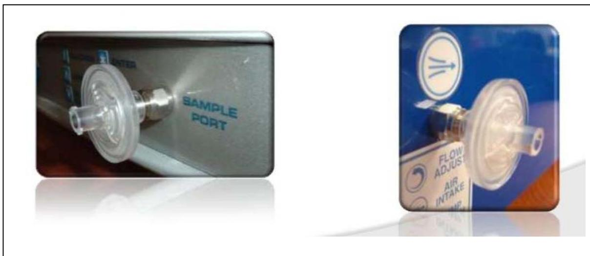
Il **QT01140-K** è un filtro con membrana in PTFE idrofobo (da 0,22  $\mu$ ) che deve essere collocato all'ingresso dell'aria di trasporto sul retro dello strumento così come all'ingresso del campione sul frontale dello strumento.
