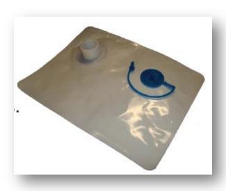
Queste sacche, saldate a caldo ed impermeabili ai gas, sono costruite con un sandwich di fogli a base polimerica separati da un foglio a base metallica e con superfici interne non trattate e prive di sostanze contaminanti.
